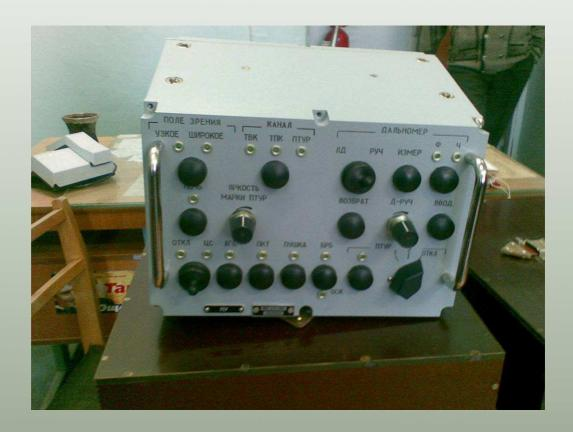
1.3.1.2 Пульт управления (ПУ) предназначен для выполнения задач по управлению огнем и юстировке, а также выполнения заряжания пушки, установки количества боезапаса пушки и гранатомета и приведения боевого модуля в походное положение..
