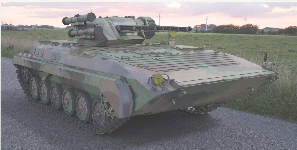
Применяется для установки транспортно – пускового контейнера ТПК- 2 на боевой машине. Транспортно – пусковой контейнер вводится до упора в пазы направляющей до автоматического срабатывания зацепов.
