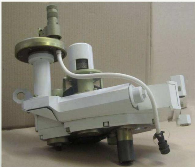
Применяется для поворота башни на требуемый угол в азимутальной плоскости. Механизм обеспечивает привод поворота в двух режимах: механическом, - от электродвигателя постоянного тока мощностью 500 Вт и ручном.
