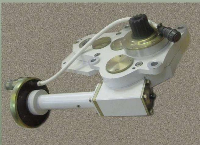
Применяется для наведения оружия, установленного в башне, в вертикальной плоскости.
