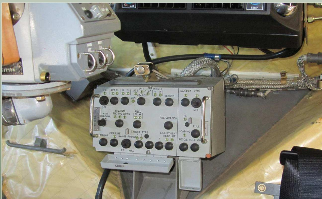
Пульт оператора (ПО) предназначен для управления подачей в изделие напряжения +27 В, выполнения задач по управлению огнем и юстировке (п. 1.3.1.3 ) при назначении его управляющим огнем, а также выполнения заряжания пушки, установки количества боезапаса пушки и гранатомета и приведения боевого модуля в походное положение.
