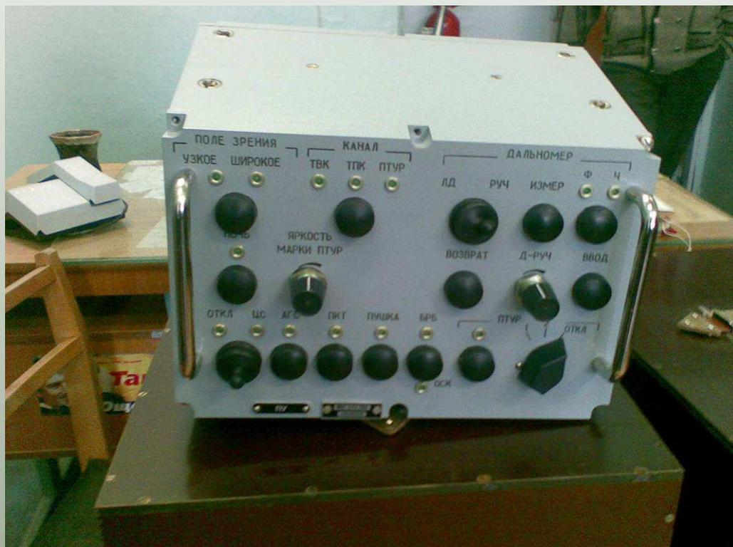
1.3.1.2 Пульт управления (ПУ) предназначен для выполнения задач по управлению огнем и юстировке, а также выполнения зарядки пушки, установки количества боезапаса пушки и гранатомета и приведения боевого модуля в походное положение..
