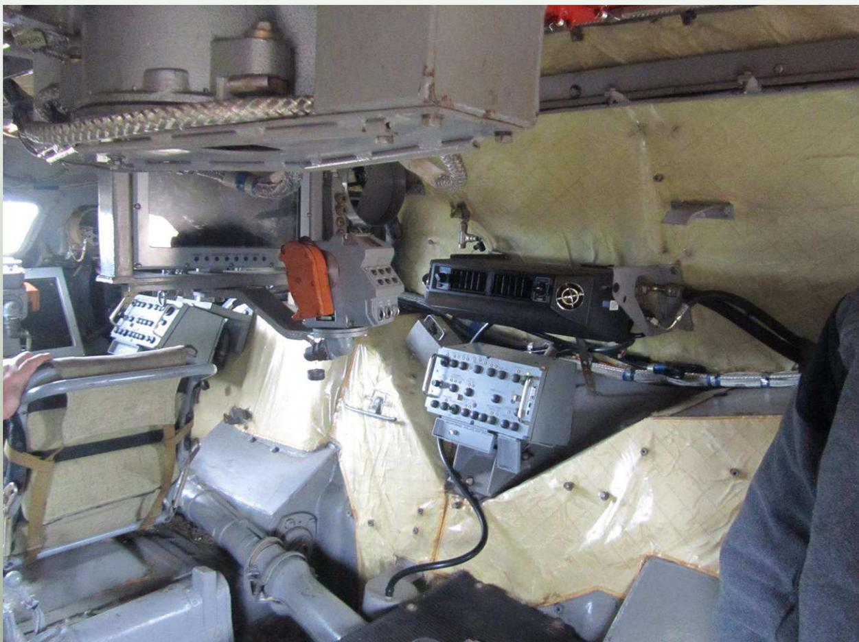
Пульт командира (ПК) предназначен для работы с панорамным прибором, организации взаимодействия с оператором, а также выполнения задач по управлению огнем и юстировке.
